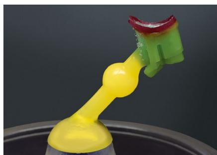
Bouchon en cire pour cône de coulée
