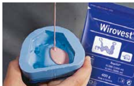
Remplissage du revêtement pour coulée sur modèle
