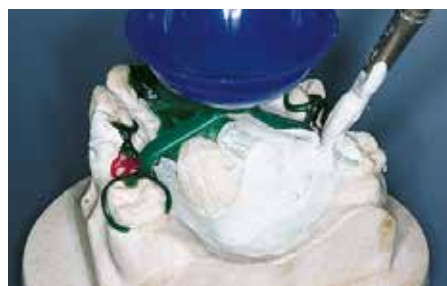
Surfaces de coulée très lisses avec Wiropaint plus, modèle avec socle rapporté
