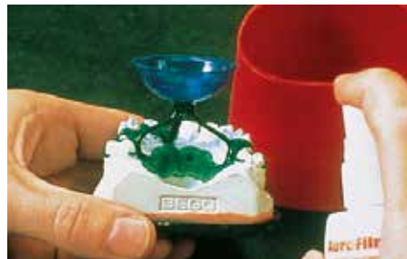
Vaporisation d'Aurofilm sur la surface de cire, modèle sur socle fixé à la cire
