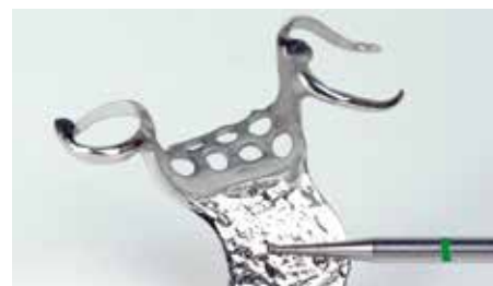
Prépolissage et polissage final du chrome-cobalt (RÉF. 52310)
