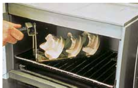
Séchage des modèles en revêtement
