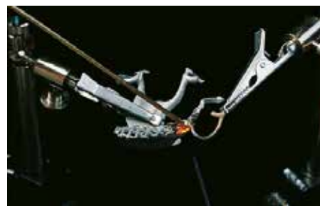
Fixation par brasage d'un crochet en or confectionné
